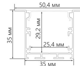
**CAB255** - встраиваемый профиль для создания световых линий на подвесных потолках любого типа.
